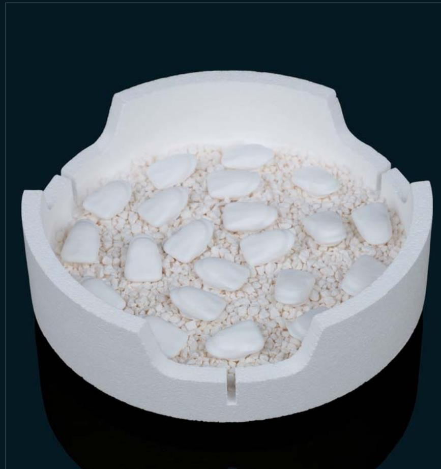
*Para evitar marcas de presión en la zirconia durante la sinterización, las unidades no deben tocarse entre sí al colocarlas en las bandejas. Para evitar la deformación de las estructuras, el fondo puede cubrirse con granulado de sinterización.*
