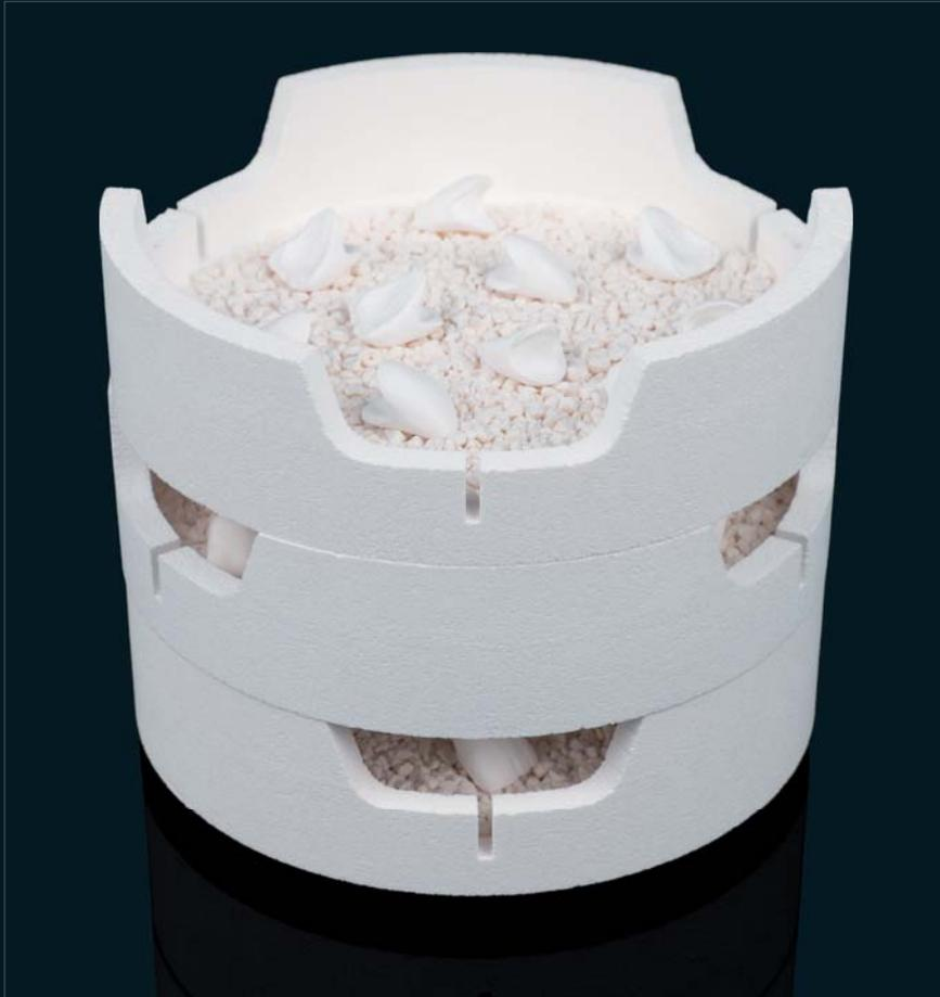
*La cámara de sinterización cuenta con suficiente espacio para colocar hasta tres bandejas puestas una sobre otra. De esta manera es posible colocar hasta 120 unidades de zirconia para sinterizarlas en un solo proceso.*
