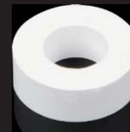
**¡NUEVO!** Anillo de calibración de temperatura para el Zirkonofen Turbo (ZBAC9081): Contenido: 10 piezas. Anillos de control de temperatura para la calibración de la temperatura del Zirkonofen Turbo. Se requiere tener un tornillo micrométrico (o similar) para medir el diámetro.
